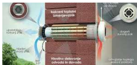
Lokalni prezračevalni sistem z vračanjem odpadne toplote
